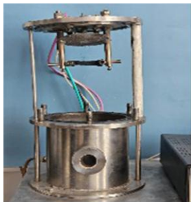
Նկար 5: Արագադործ ջերմաստիճանային սկաներ, աշխատանքի ռեժիմները:
