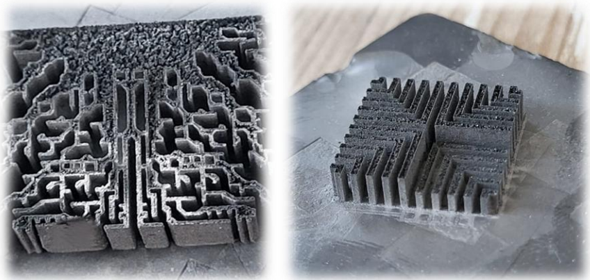
Նկար 11: ԸԼՀ մեթոդով կոմպակտավորված բարդ կառուցվածքով նմուշներ:
